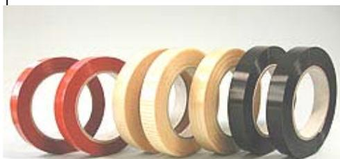
NASTRO ADESIVO AD ALTA RESISTENZA REALIZZATO CON L'ACCOPIAMENTO DI FILM IN POLIPROPILENE CON FIBRE DI VETRO IN SENSO LONGITUDINALE (RU) E INCROCIATE LONGITUDINALI E TRASVERSALI (RX). UTILIZZATO PER LA CHIUSURA DI SCATOLE MOLTO PESANTI ED IN QUEI SETTORI DELL'IMBALLAGGIO DOVE È RICHIESTO UN ELEVATO CARICO DI ROTTURA ED UN' ALTA ADESIVITA'.
