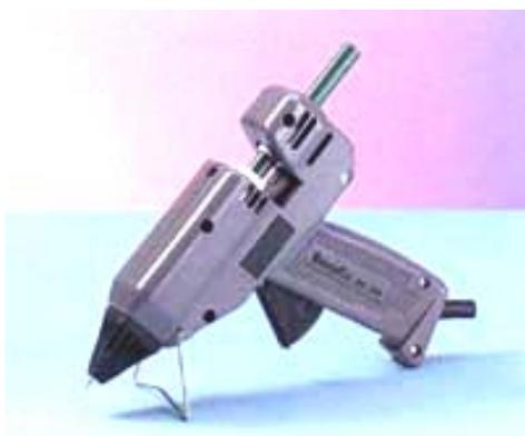
Pistola incollatrice professionale. Forcella di appoggi per una maggiore stabilità, ugello con protezione termica avanzamento meccanico dello stick, temp. di fusione 180°
