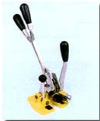
PER REGGIA POLIPROPILENE DA MM 12 O MM 15 - SPESSORE MM 0,6-0,8
